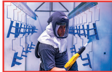
Pulverbeschichtung: Der Pulverlack wird mit der Handpistole aufgetragen
